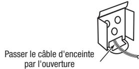
4. Passez le câble d'enceinte par l'ouverture en forme d'arc située sur le dessus du support de montage, pas par le trou destiné à la vis.
